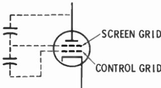
**GRID-PLATE CAPACITANCES IN A TETRODE**
