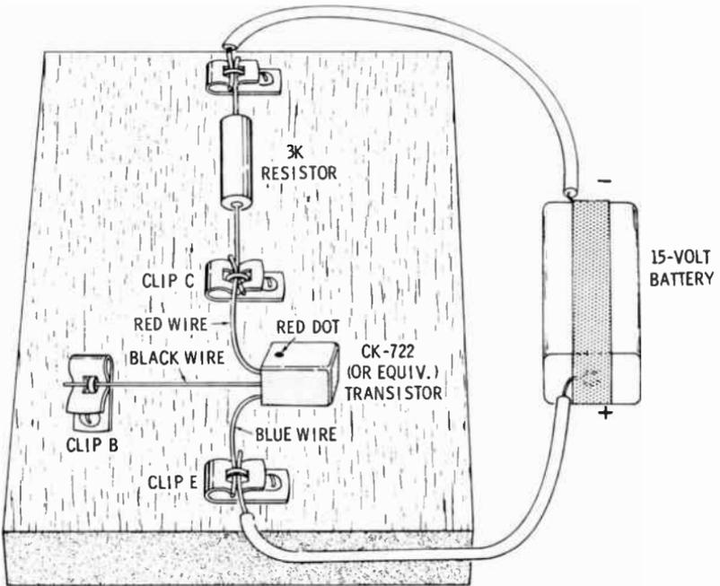
**A TRANSISTOR VOLTAGE DIVIDER**
