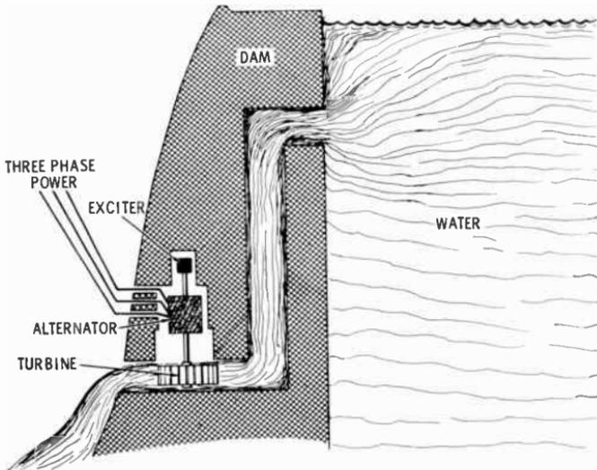
**HYDROELECTRIC GENERATING PLANT**
