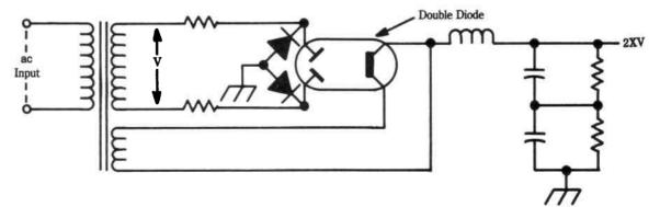
Fig. 25-9. Voltage-multiplier circuit.
