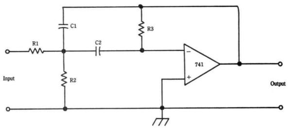
Fig. A-11. Band pass filter.
