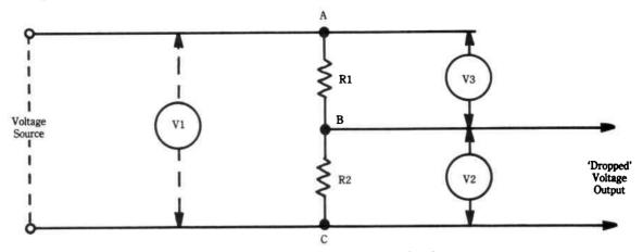
Fig. 3-7. Basic potential divider circuit.
