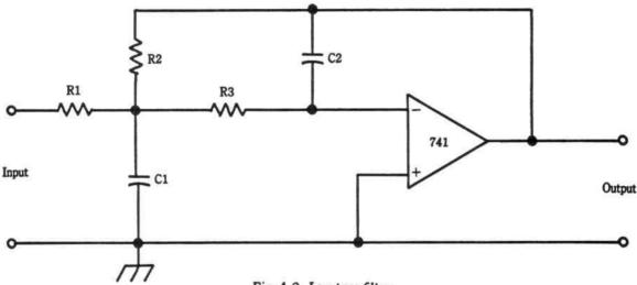
Fig. A-9. Low-pass filter.
