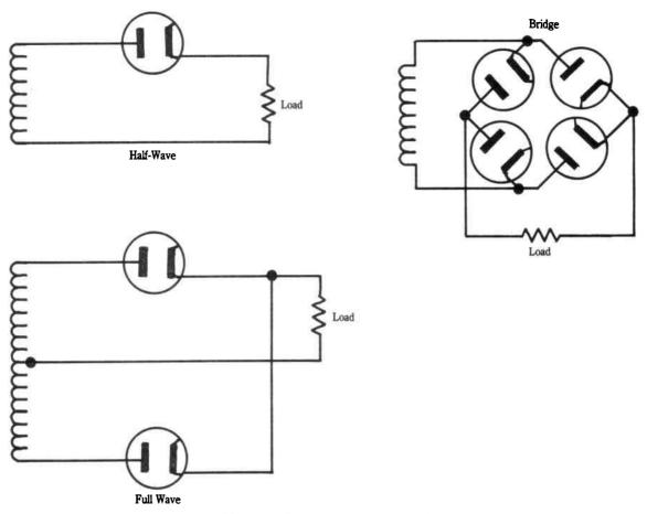
Fig. 25-1. Three basic rectifier circuits.
