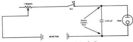
Fig. 10-4. Morse code flasher circuit.
